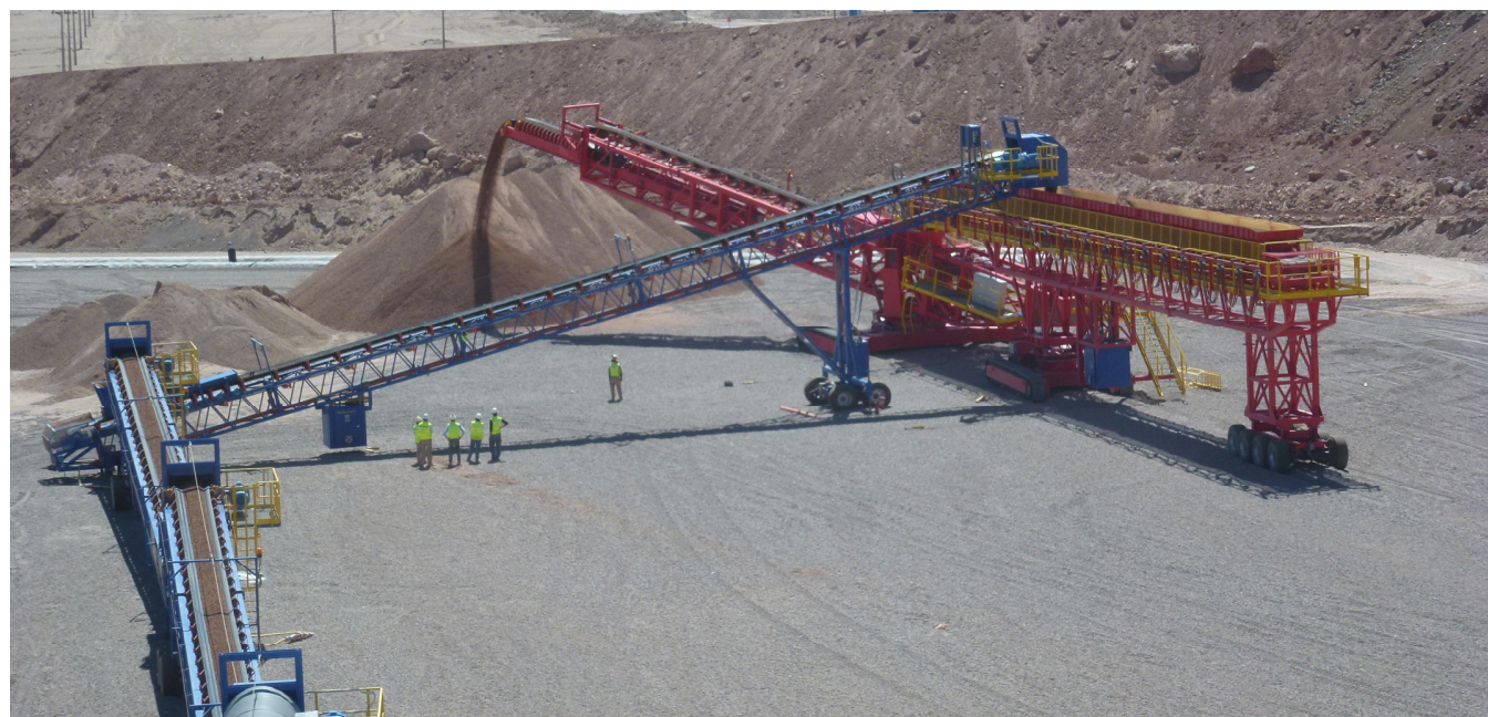
Sistema de Apilado Semicontínuo en Mina Ministro Hales - Chile
