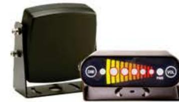
El sistema Anticolisión por radar modelo PSRADAR DREAMVIEW detecta objetos tanto en movimiento como en estado estacionario en una área de cobertura predefinida de hasta 30 metros, relata la distancia del objeto más cercano por medio de indicadores de alcance visual y una señal sonora al operador del vehículo que se puede integrar a nuestro sistema de cámara Dreamview.
