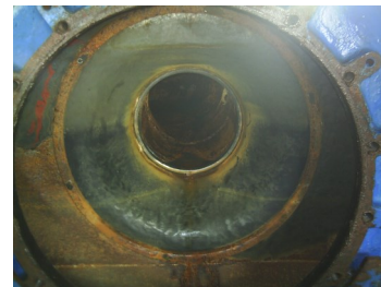
Tapa Espejo de Bomba pesquera recubierta con RELLENO METALICO - RELLENON
