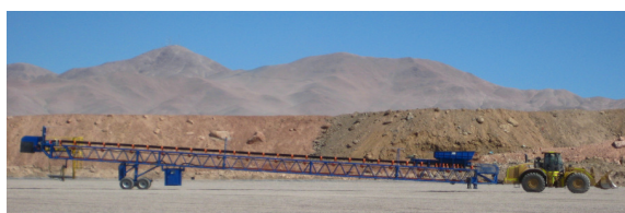
Movimiento de grasshopper mediante pala CAT980H – Mina Ministro Hales
