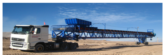
Transporte de grasshopper realizado por carretera desde Mina Ministro Hales a Mina Gabriela Mistral - Chile
