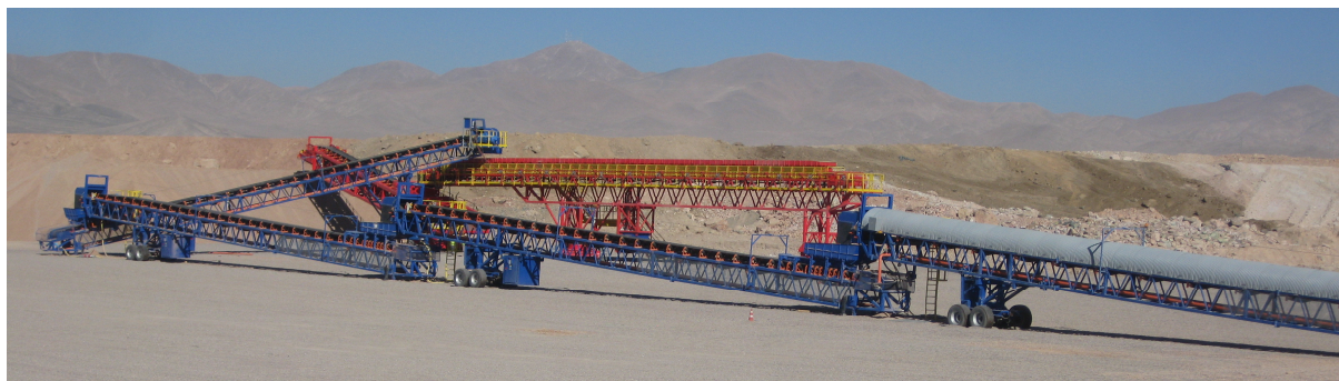
Sistema semicontínuo de apilado. Mina Ministro Hales (Chile)
