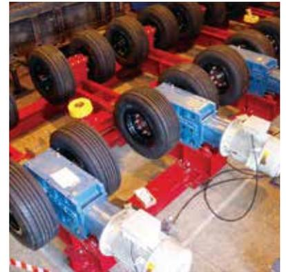
Sistema de tracción de accionamiento con neumáticos Sepro (PTD)
